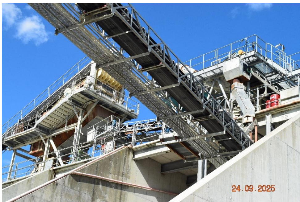
FIGURA 5 - VISTA DEL GRUPPO CICLONATURA E SELEZIONE SABBIE IMPIANTO 2 "CALBANA" - CAVA "RIPA CALBANA" - BORGHİ (FC)
